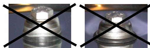
1.6 Ziehen Sie die Kabeldichtung an (Anzugsmoment: 5 N.m +/- 0,5).
