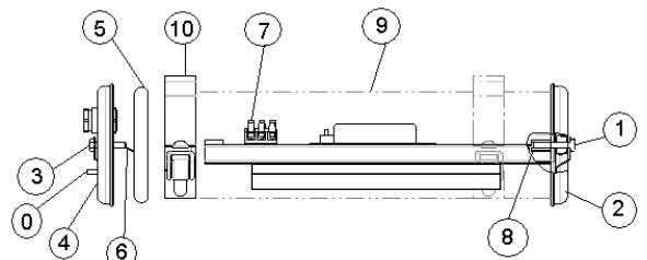
1.3 Montieren Sie die Leuchte in die Befestigungsklemmen ⑩, nachdem Sie diese wie in § 1.1 beschrieben, befestigt haben.
